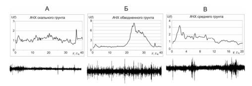
Рис. 7. АЧХ и акселерограммы на разных по составу и состоянию грунтах. А – скальные грунты, Б – рыхлые водонасыщенные, В – «средние» грунты площадки исследований
