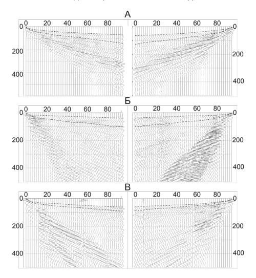
Рис. 6. Примеры сейсмограмм, зарегистрированных на разных по составу и состоянию грунтах: A – средние грунтовые условия, B – обводненные грунты, B – скальные породы
