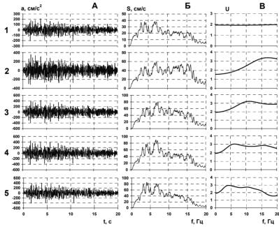
Рис. 10. А – акселерограммы, Б – их амплитудные спектры, В – частотные характеристики рыхлых слоев (для горизонтальной компоненты; слева указаны номера моделей)
