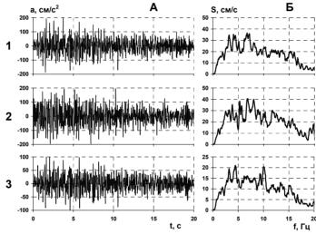
Рис. 9. Сформированный сейсмический сигнал для коренных «эталонных» грунтов для территории аэропорта с принятой исходной сейсмичностью, равной 9 баллам. А – исходные акселерограммы, Б – соответствующие им амплитудные спектры Фурье: 1 – для NS, 2 – для EW, 3 – для Z компоненты
