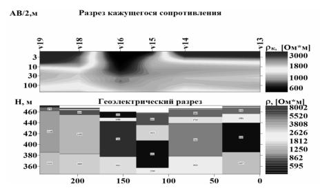
*Puc.* 5. Результаты интерпретации ВЭЗ по профилю ПР4, расположенному вкрест оси простирания предполагаемого разлома
