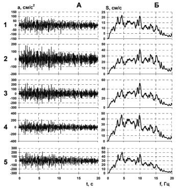
*Puc. 11.* А – акселерограммы, Б – их амплитудные спектры (для вертикальной компоненты; слева указаны номера моделей)
