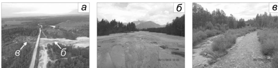
Рис. 4. Селезащитные мероприятия в долине р. Кынгарги в окрестностях с. Тагархай: панорамный снимок БПЛА (*а*), показывающий нарушенность долинных ландшафтных комплексов в результате создания берегоукрепительных валов выше моста через реку (*б*), которые уничтожили елово-сосновые с ивой травяные леса (*в*), сохранившиеся в долине ниже моста (стрелками указаны места, отраженные на врезках *б* и *в*)
