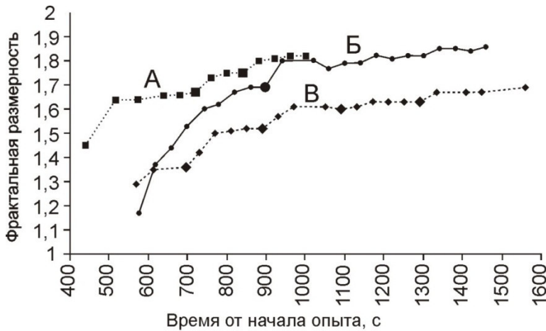
Рис. 3. Графики изменения фрактальной размерности сети разрывов в моделях разломных зон растяжения (А), сдвига (Б) и сжатия (В). Крупными значками на графике отмечены моменты времени, предшествующие контрастному увеличению параметра
