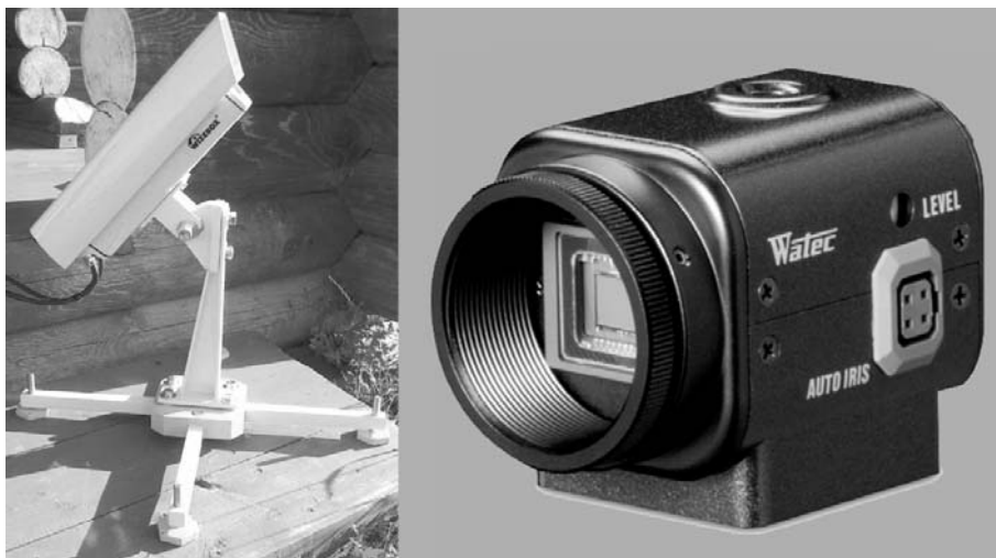
Рис. 2. Детектор в сборе (слева) и CCTV-камера Watec Wat-902H2 Ultimate (справа)
