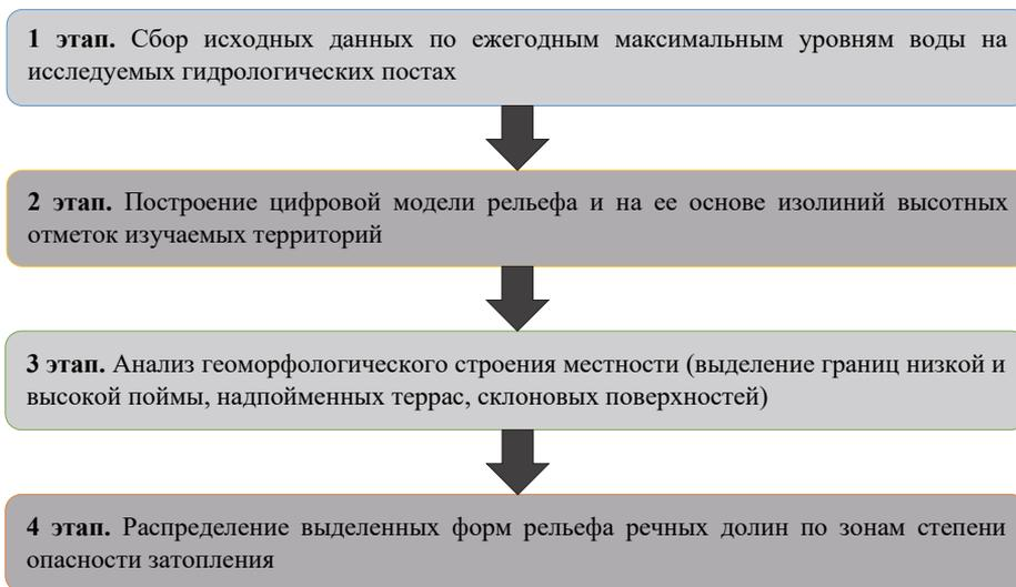
Рис. 1. Основные этапы определения зон по степени опасности затопления при наводнениях для городов Тулун, Нижнеудинск и Бирюсинск
