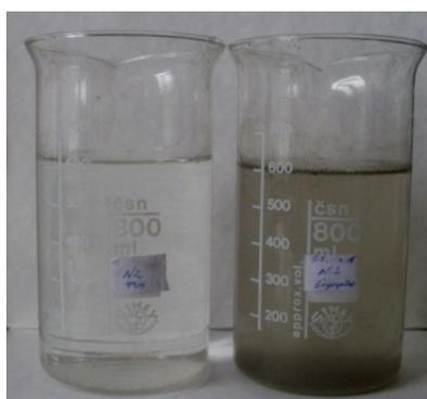
Рис. 6. Пробы снега: фоновая (в лесу) – слева, у водозабора – справа
